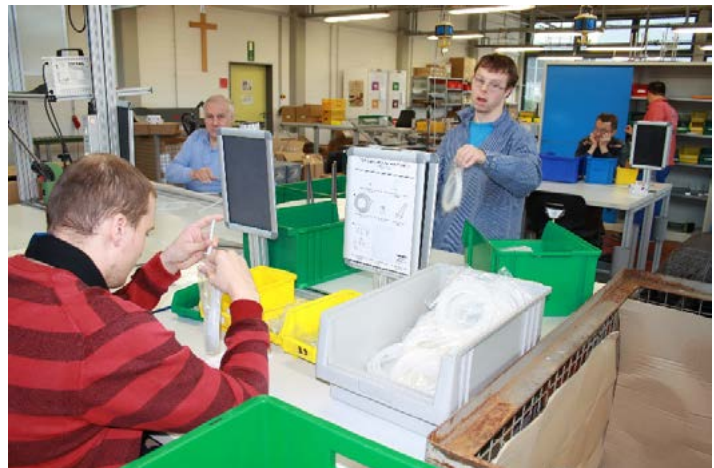
Bild 2: An diesen Arbeitsplätzen in den Neckartalwerkstätten des Caritasverbands für Stuttgart e.V. soll durch das Assistenzsystem der Packprozess mit Hilfe optischer Sensorik auf korrekte Ausführung überprüft werden. (Quelle: Neckartalwerkstätten des Caritasverbands für Stuttgart e.V.)
